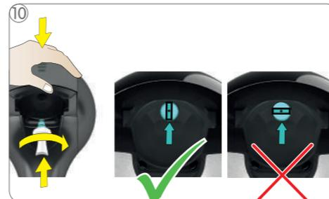
Insérez l'injecteur par le bas dans l'ouverture de la machine. Tenez l'injecteur à la main. Tournez l'injecteur dans le sens horaire jusqu'à ce qu'il soit en place. Suivez les instructions au chapitre «8. DETARTRAGE TOUS LES 3 – 4 MOIS AU MOINS» à la page 13.
