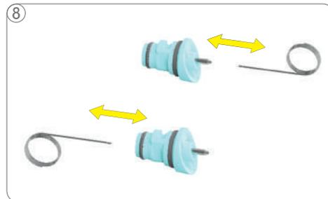
Insérez l'aiguille de nettoyage dans l'injecteur pour le déboucher. Si c'est impossible, préparez une solution détartrante avec un sachet et 0,5 l d'eau potable. Trempez l'injecteur dans la solution.
