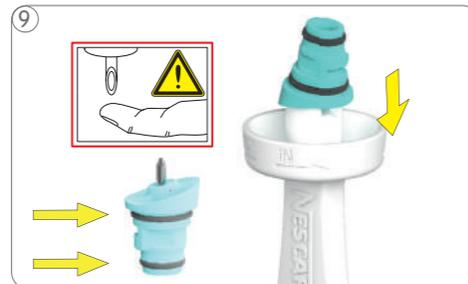
Vérifiez si les deux joints toriques sont intacts et à la bonne place sur l'injecteur. Placez l'injecteur sur l'outil.
