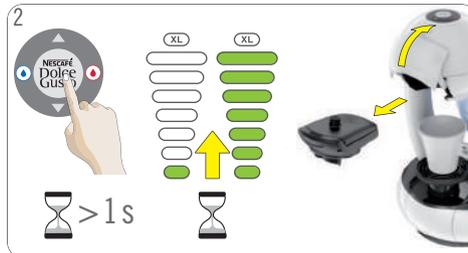
Démarrez la machine. L'affichage du volume s'éclaire progressivement au fur et à mesure que la machine chauffe, pendant 40 secondes environ. Ensuite, l'affichage du volume indique le dernier réglage de volume. Ouvrez la poignée de verrouillage. Sortez le porte-capsule.
