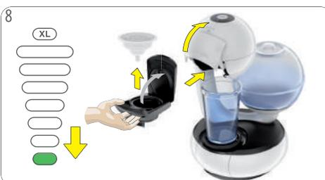
Attendez la fin du compte à rebours. La machine s'arrête. Ouvrez la poignée de verrouillage. Sortez le porte-capsule. Ouvrez le porte-capsule. Enlevez l'accessoire de rinçage. Placez-le en lieu sûr pour un nettoyage ou un détartrage ultérieurs. Réinsérez le porte-capsule.
