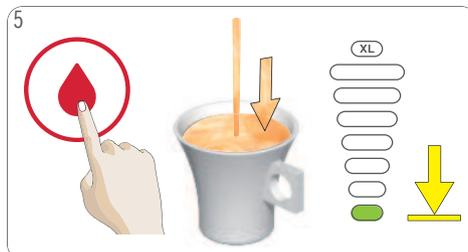
Appuyez sur le bouton eau « CHAUDE » ou « FROIDE » comme conseillé sur les paquets de capsules. La préparation de la boisson commence. Attendez la fin de l'extraction. L'éclairage de l'affichage de volume disparaît progressivement. La machine arrête la préparation automatiquement. L'extraction peut être arrêtée à tout moment manuellement en réappuyant sur le bouton eau « CHAUDE » ou « FROIDE ».
