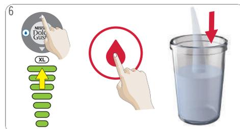
Mettez l'affichage du volume sur 7 à l'aide des boutons de volume. Appuyez sur le bouton eau « CHAUDE ». Le rinçage démarre. L'éclairage de l'affichage du volume s'éteint progressivement.
