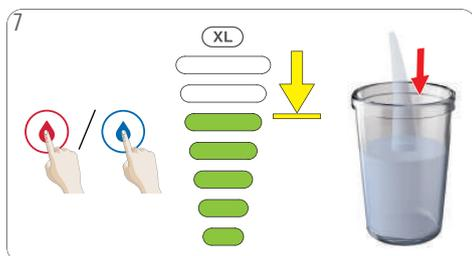
Appuyez sur le bouton eau « CHAUDE » ou « FROIDE ». L'éclairage de l'affichage de volume disparaît progressivement. La machine se détartre à l'eau chaude en mode marche/arrêt pendant 2 minutes environ. L'extraction peut être arrêtée à tout moment manuellement par une pression sur le bouton eau « CHAUDE »/« FROIDE ».
