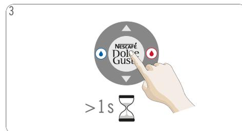
Pour arrêter la machine, appuyez sur le bouton marche/arrêt pendant au moins 1 seconde. La machine s'arrête automatiquement après 5 minutes de non-utilisation.
