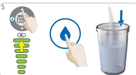
Mettez l'affichage du volume sur 7 à l'aide des boutons de volume. Appuyez sur le bouton eau « FROIDE ». Le rinçage démarre. L'éclairage de l'affichage du volume s'éteint progressivement.
