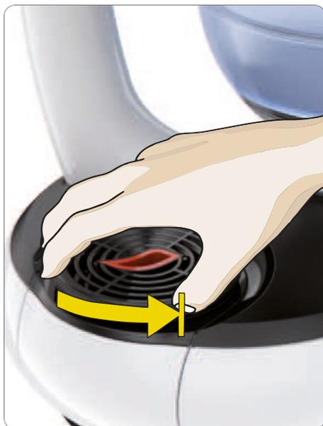
Pour ajuster la position du bac d'égouttage : Tournez le bac d'égouttage dans le sens antihoraire pour le déverrouiller.
