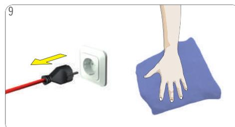
Éteignez la machine. Débranchez la fiche de courant ! Nettoyez la machine avec un chiffon doux humide. Essuyez-la avec un chiffon doux sec.
