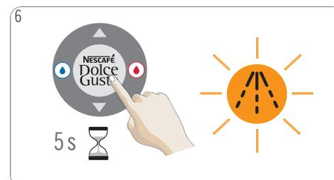
6 Appuyez sur le bouton marche/arrêt pendant 5 secondes au moins. Le témoin lumineux orange de détartrage commence à clignoter et la machine passe en mode détartrage.
