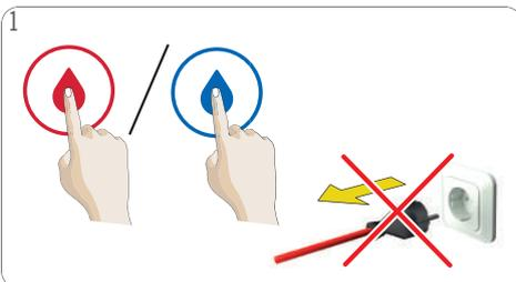
1 Laissez toujours la machine debout ! Pour arrêter la préparation, appuyez de nouveau sur le bouton eau chaude/froide. Ne débranchez pas la machine !
