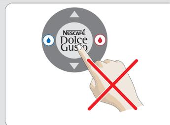
N'appuyez pas sur le bouton marche/arrêt (ON/OFF) pendant le cycle de détartrage.
