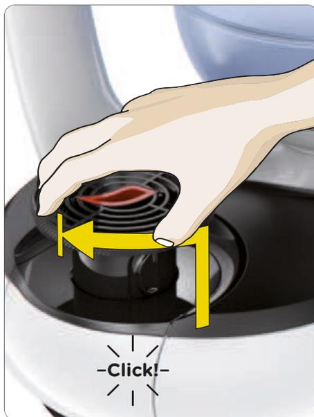
Relevez le bac d'égouttage jusqu'en position médiane. Tourner le bac d'égouttage en le tournant dans le sens horaire jusqu'au clic. Le bac d'égouttage est verrouillé.
