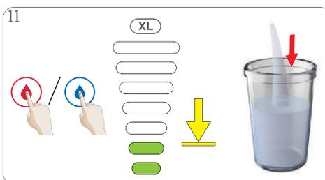
Appuyez sur le bouton eau « CHAUDE » ou « FROIDE ». L'éclairage de l'affichage de volume disparaît progressivement. La machine rince à l'eau chaude en continu. L'extraction peut être arrêtée à tout moment manuellement par une pression sur le bouton eau « CHAUDE »/« FROIDE ».
