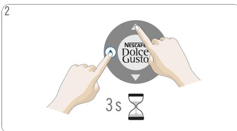
2 Lorsque des instructions apparaissent, confirmez l'appairage dans un délai de 10 secondes en appuyant sur le bouton « FROID ». Appuyez sur les boutons « FROID » et « EN HAUT » pendant 3 secondes.
